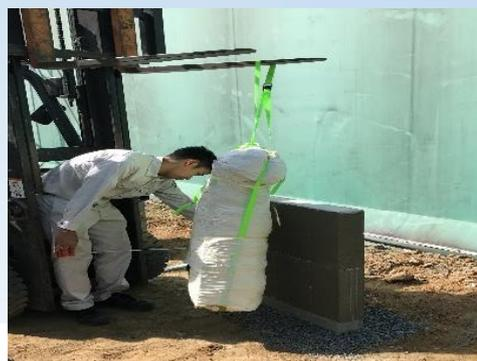
折れ、破断は見られなかったためJISの規定する試験を合格した。
