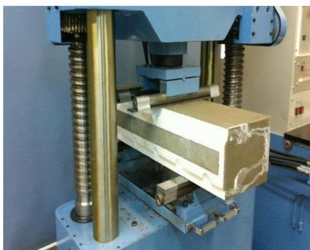
曲げ荷重試験 鉄筋なしで約1t/m<sup>2</sup>以上
