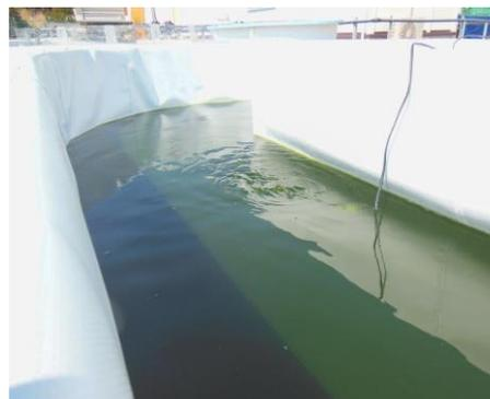
ホームガードで水槽を作成した水圧試験
